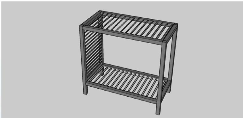
Die Variante beinhaltet: Pulverbeschichtete Aluminiumkonstruktion in beliebiger RAL-Farbe, aufgebaute Dachkonstruktion aus Aluminiumkammerpaneelen, die in gewählter RAL-Farbe lackiert sind, mit beweglichem Paneelensystem (Jalousie), eingebaute Rückwand aus Aluminiumkammerpaneelen, die in gewählter RAL-Farbe lackiert sind, mit beweglichem Paneelensystem (Jalousie), zwei Rahmen, zwei Matratzen in beliebig erhältlicher Stofffarbe, Standardfüße, Befestigungsschrauben.
